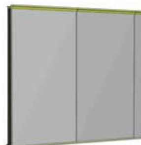
天井や床、または隣接部分の 壁100mm程度重複させる
