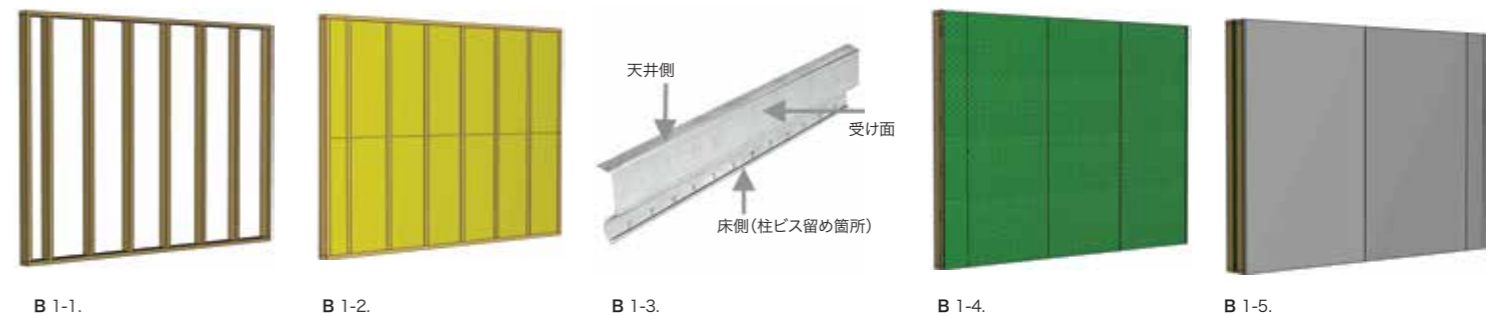
B 1-1. B 1-2. B 1-3. 防振金物 (北米仕様のレジリエント・チャンネル) B 1-4. B 1-5.
